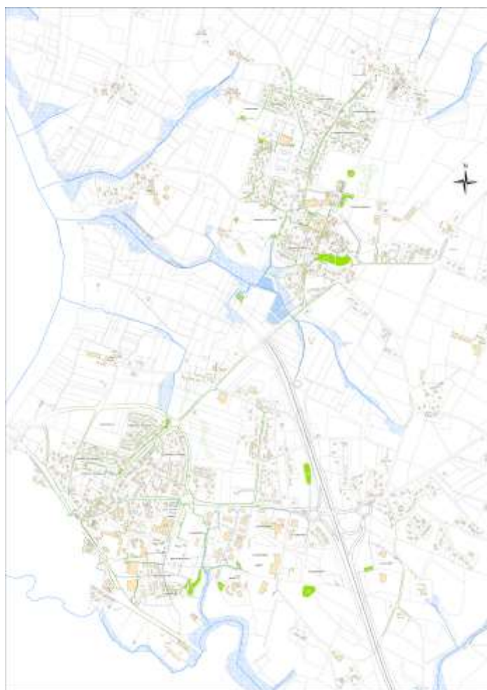
FIGURE 16 : RESEAU PLUVIAL ET BASSINS TAMPONS EXISTANTS
