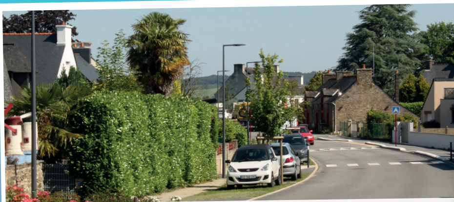
La rue Nationale à Colpo a été débarrassée de tous ses réseaux aériens et poteaux béton d'éclairage public sur trois kilomètres pour faire place uniquement à 19 mâts de six mètres avec lanternes de 54 Watt.
