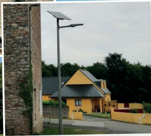
Derrière la mairie, à Limerzel, quatre mâts solaires, sains de tout ombrage, éclairent la rue de l'école, sans qu'il ait été nécessaire de creuser la chaussée, avant la pose de quatre autres.
